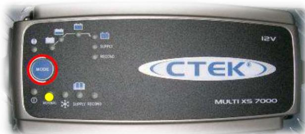
Si la batterie du véhicule est débranchée et la prise 230V n'est pas branchée, le chargeur de batterie doit être reconfiguré manuellement. Pressez le bouton MODE jusqu'à ce que la lampe LED "NORMAL" soit allumée.
