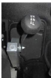
Le mode "vitesses réduites" permet de rouler dans des pentes très abruptes, à pleine charge.
