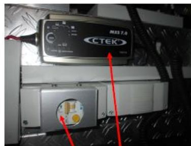
Interrupteur de sécurité FI 230 Volts et chargeur de batterie latéralement à la console du milieu
